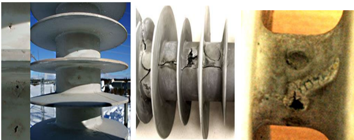
Рис. 7 Примеры повреждения корпуса (или пробоя) на разных изоляторах.
