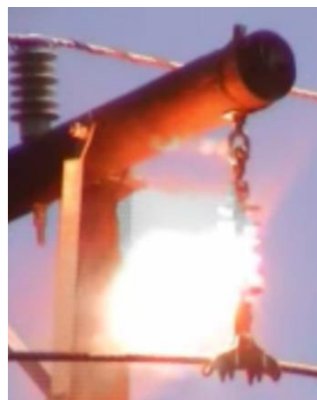
б) Вспышка на проводящем стержне к корпусу
